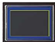
Capteur APS-C (16X24mm) Reflex Amateur 2 fois plus petit que le plein format
