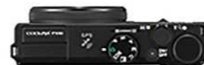
Capteur 1/1.7" (7,6X5,7mm) Compact haut de gamme 20 fois plus petit que le plein format
